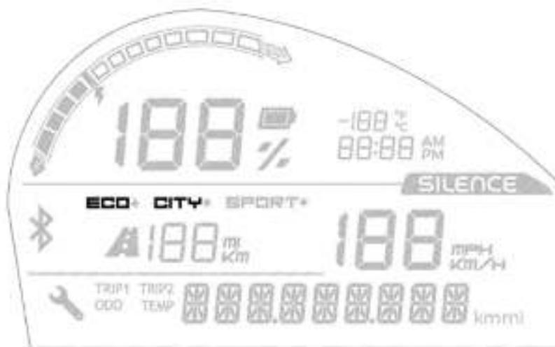
Una sola pulsación cambiará entre los modos ECO y CITY. Durante la transición entre un modo y otro, el nombre del modo siguiente se mostrará intermitente en pantalla unos segundos y se activará quedándose fijo.
