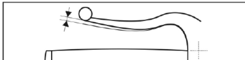
Antes de activar el icono “D” (scooter listo para poder ser usado), hay que asegurarse de que el sistema de frenado actúa correctamente: Apretar la maneta de freno izquierda y derecha al mismo tiempo para percibir si ambos presentan resistencia a la presión.
