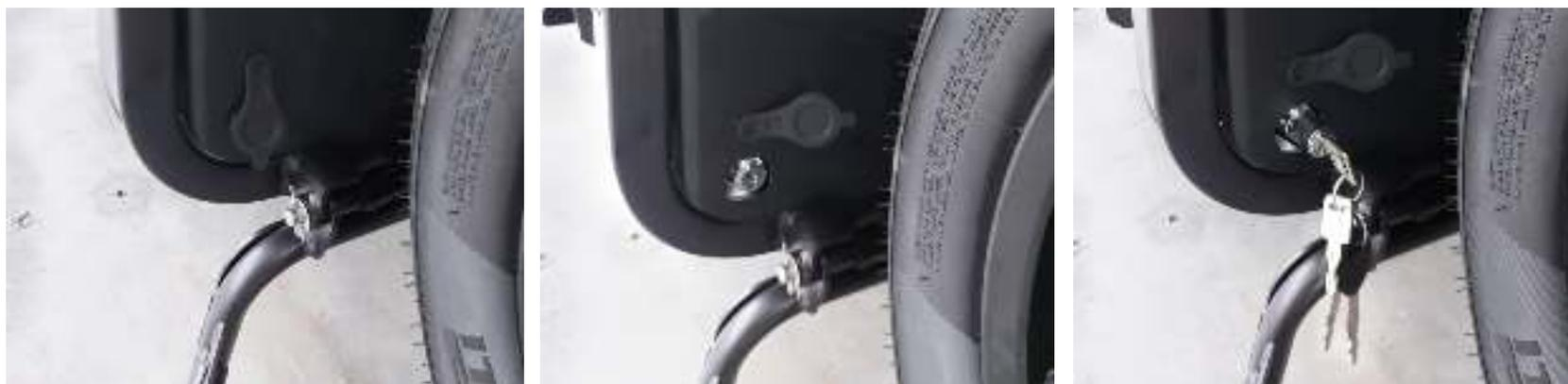
**IMPORTANTE:** Asegurar no extraer ni introducir el pack de baterías cuando esté la moto cargando ni cuando esté el contacto dado. Asegurar **no desplegar el asa antes de tirar hacia afuera el pack** (desplegarla una vez la batería esté fuera de la moto).
